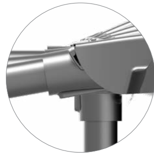
Fixation universelle avec réglage de l'inclinaison par pas de 5°. Universal mounting piece for side-entry or post-top mounting. Universal verstellbar System in der Leuchte für Ausleger und Mastzöpf.
